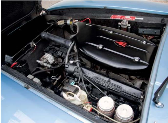
**Vollalu-V8 mit Renn-Vergangenheit: vier Vergaser und Nockenwellen, fünf-fach gelagerte Kurbelwelle, elf Liter Ölinhalt, neunzig Grad Zylinderwinkel. Dieser Typ Maserati-Motor gilt als robust und wurde bis 1990 verbaut**
